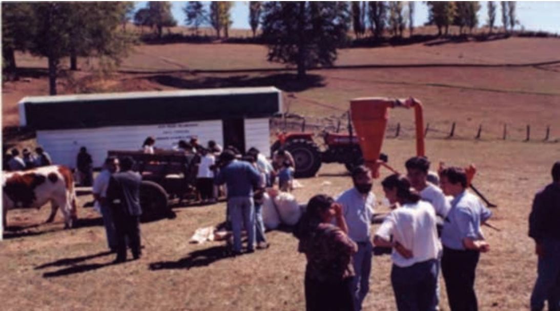
Molino harinero prestando el servicio en Malloco Lolenco. Junto con la molienda, se chancaban cereales y fardos de pasto. De la máquina chancadora se observa el ciclón de color naranja. Archivo fotográfico Museo Leandro Penchulef.
